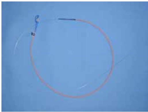
図5 外形 0.5mm のキャピラリー温度センサー Fig.5 Capillary temperature sensor with 0.5mm 0 D.
